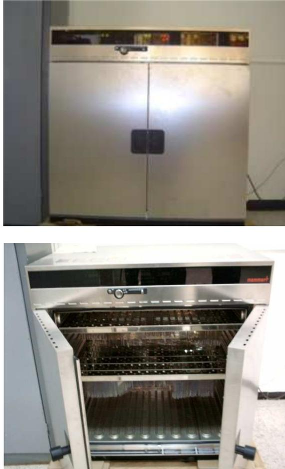
Figure V.2: Etuve de vieillissement thermique.
