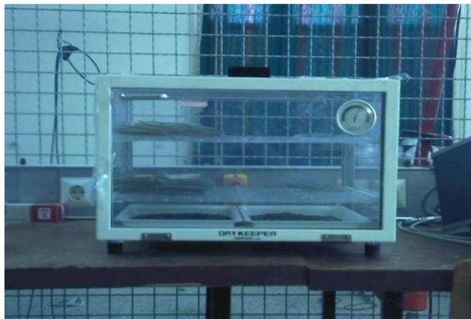
Figure V.9: Dessiccateur avec échantillons au cours de conditionnement.
