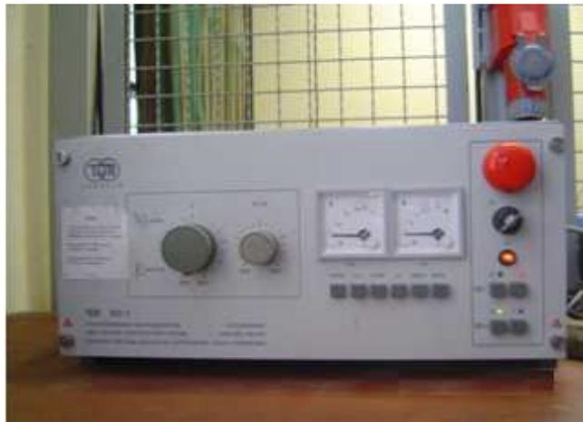
Figure V.4: Générateur basse tension SG1.
