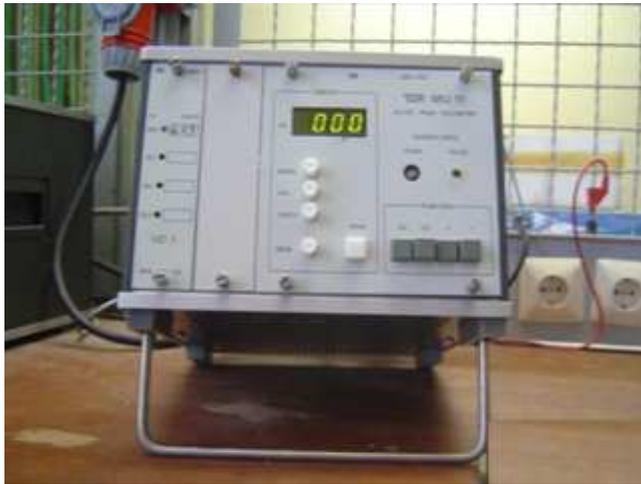
Figure V.6: Voltmètre de crête MU11.
