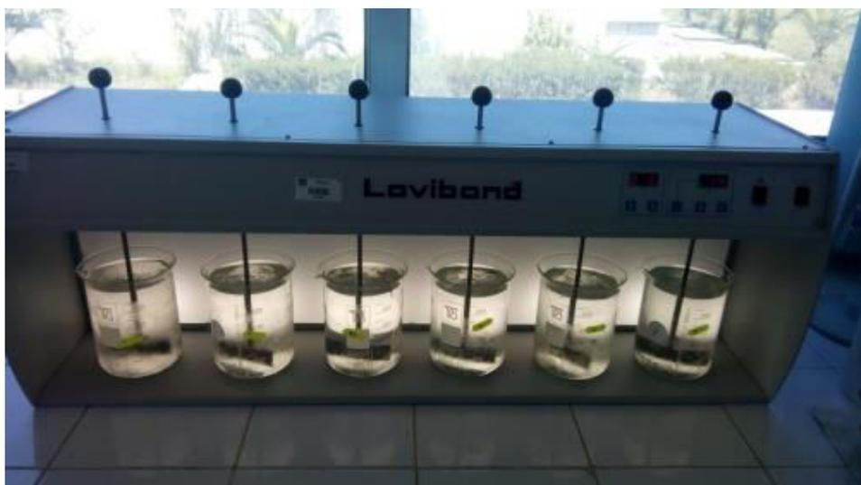
**Figure 10 : Jar-test de la station SEAAL.**
