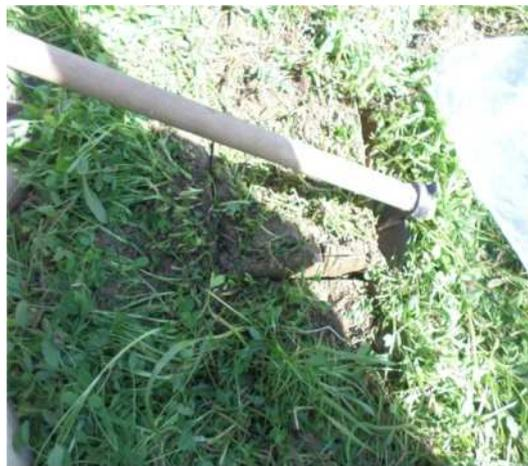
**Figure 3 :** prélèvement du sol
