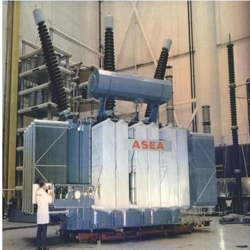
Dans un transformateur statique, l'énergie est transférée du primaire au secondaire par l'intermédiaire du circuit magnétique que constitue la carcasse du transformateur. Ces deux circuits sont alors magnétiquement couplés. Ceci permet de réaliser un isolement galvanique entre les deux circuits. Dans une commutatrice, l'énergie est transmise de manière mécanique entre une génératrice et un moteur électrique.
