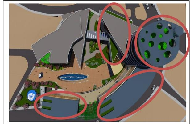
Figure75 : Positionnement des toits végétaux dans le projet
