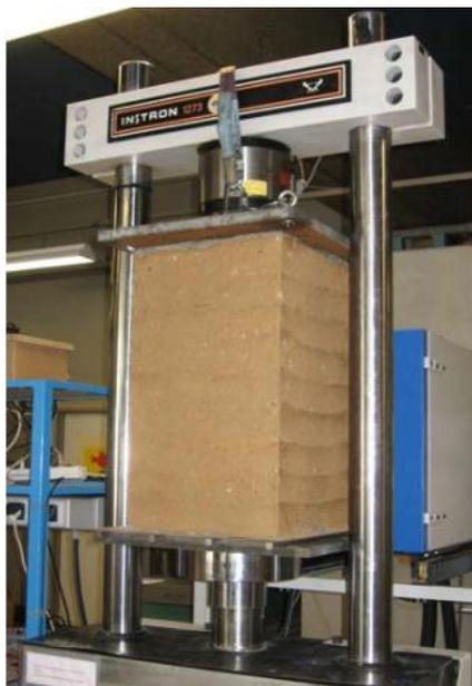
Figure 48 : l'essai de compression uniaxiale(Bui.Q.B, 2008)
