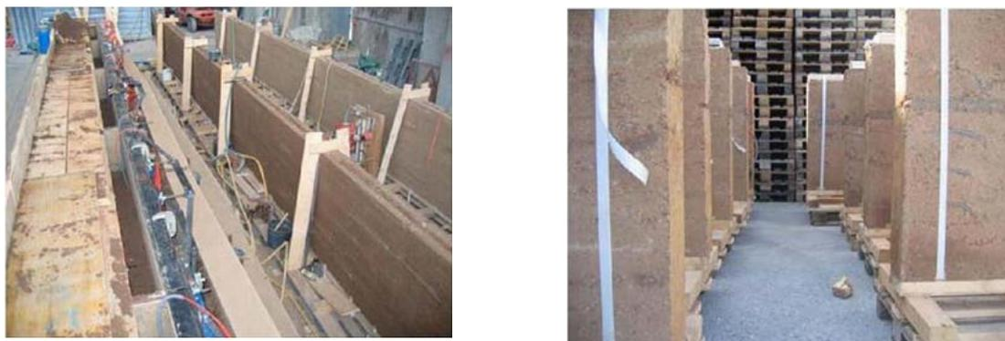
Figure 28 : Prêfabrication des pisé dans une usine, en Autriche (Rauch, 2007)
