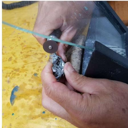
**Figure 71 Découpage des tiges de coulée à l'aide d'un disque en carbure de tungstène**
