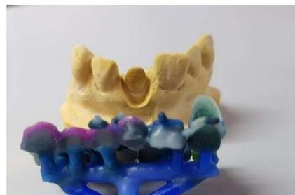
**Figure 56** Maquette en cire avec une tige de coulée
