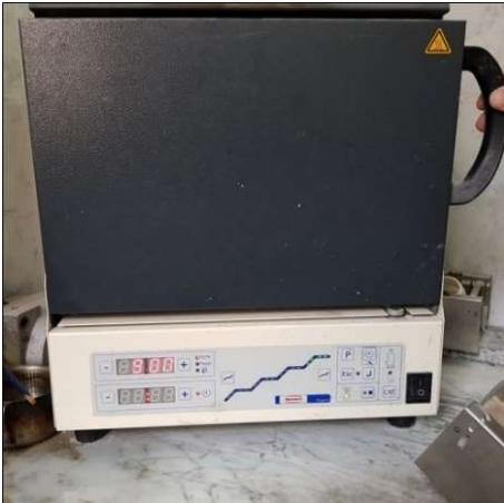
Figure 62 La fente de la cire au four
