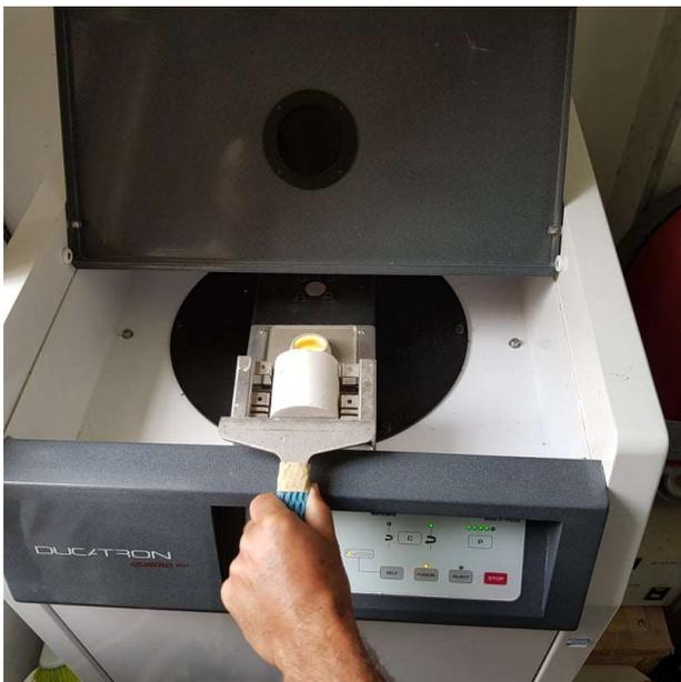
Figure 64 Mise du revêtement dans une centrifugeuse
