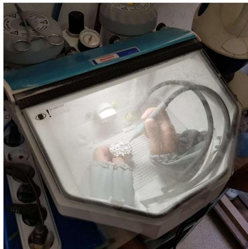
**Figure 68 Sablage de la pièce dans une machine sableuse à ultrason**
