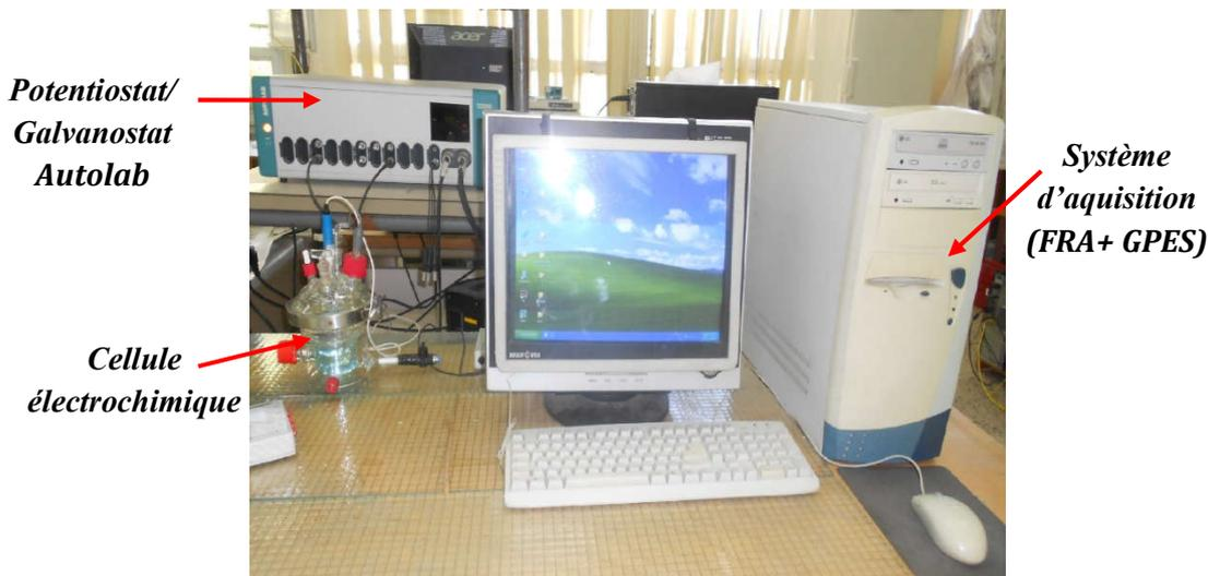
Fig. II.1 : Photographie de la chaîne de mesures électrochimiques.
