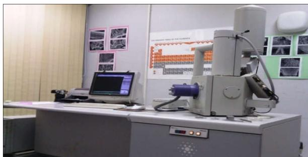
Fig. II.3 : Microscope électronique à balayage du LPCM.
