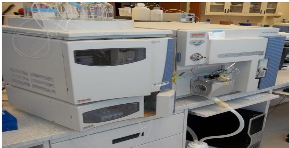
**Figure 26** : Photographie de l'appareillage de chromatographie en phase liquide couplé à un spectromètre de masse (LC-M/MS) (Thermo Scientific Fisher).
