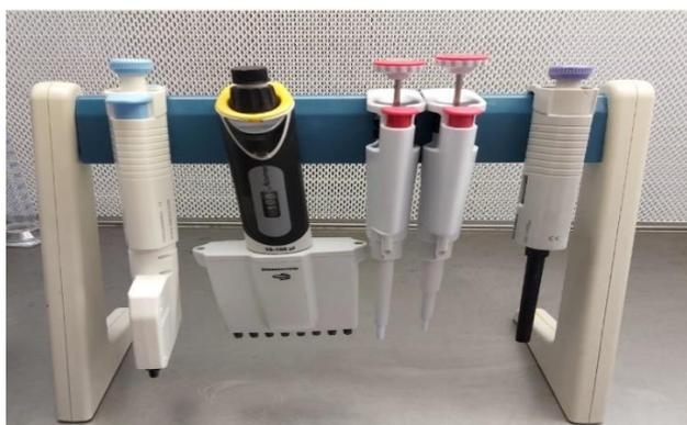
**Figure 49 :Micropipettes.**
