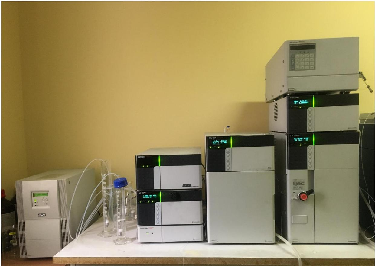
Figure 11 : Appareil HPLC.
