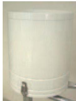
Figure 6 : Pluviomètre
