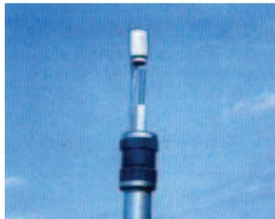
Figure2: Sonde à résistance platine
