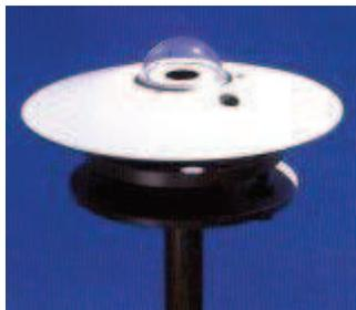
Figure 9 : Pyranomètre
