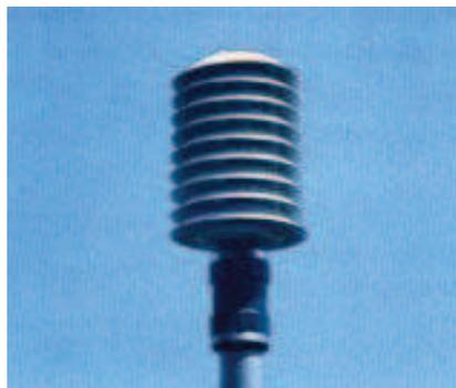
Figure 3 : Capteur de l'humidité et de température (la sonde d'humidité).
